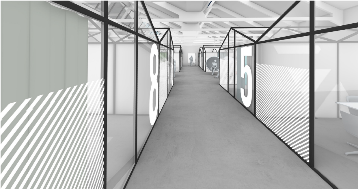
Applicazione prespaziato RAL 9010 con pattern a strisce e numeri Pattern a strisce: h 110 cm, circa 50 ml. Spessore strisce 3 cm inclinate a 45° Numeri: h 200 cm, font: BEBAS ( https://www.dafont.com/bebas.font ) (a destra tracciati di ritaglio scala 1:20)
